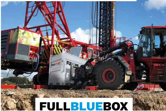
Om eenvoudig op de bouwplaats kranen en ander equipment van AdBlue<sup>®</sup> te voorzien heeft FullTank de FullBlueBox ontwikkeld. Een stalen IBC met 2.000 liter RVS tank met pompset, FullTank sensor en accukabels waardoor de FullBlueBox aan te sluiten is op iedere kraan en overal inzetbaar is. Ideaal omdat u op deze manier altijd zelf uw equipment kunt bijvullen met AdBlue<sup>®</sup>.
